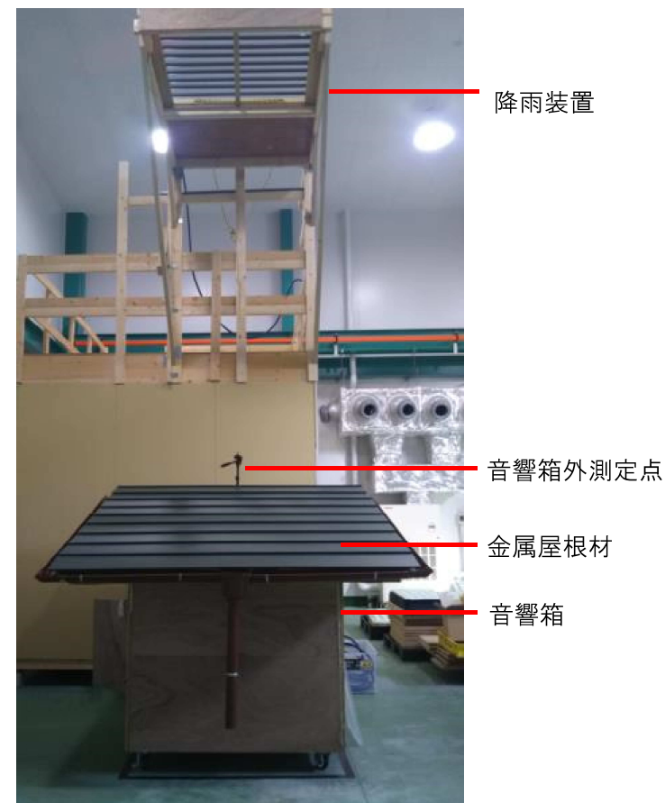
降雨騒音試験装置
